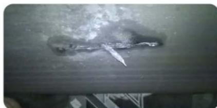
Um dos sistemas de monitoramento foi instalado em Agosto de 2019, e em fevereiro de 2020 ele já demonstrou sua eficiência. Na noite do dia 19, **uma placa metálica ficou presa no chute de carregamento e começou a danificar a correia**. O HX270 parou a correia antes do rasgo total da correia e o possível desastre foi evitado.
