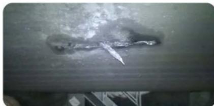
Uno de los sistemas de monitoreo fue instalado en agosto de 2019, y en febrero de 2020 ya demostró su eficacia. En la noche del 19 de febrero de 2020, **una placa metálica quedó atrapada en la rampa de carga y comenzó a dañar la correa**. El HX270 detuvo la correa antes de que se produjera una rasgadura total y se evitó un posible desastre
